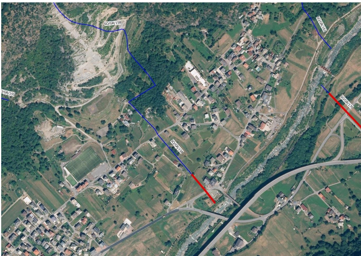
Figura 8 - Tratto terminale tombato e a cielo aperto del Torrente della Valle della Sassa
